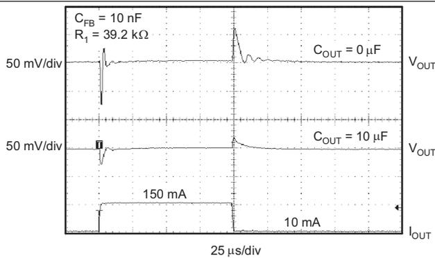
Figure 27. TPS73101 Load Transient, Adjustable Version
