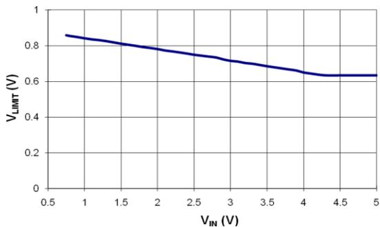
Figure 20. V<sub>IN</sub> vs. V<sub>LIMIT</sub>
