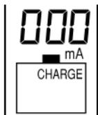
Если аккумуляторы перегреты, зарядка автоматически прервется, и на экране отобразится "000 mA"
