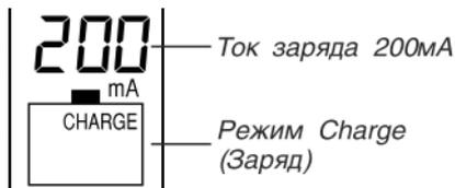
Во время работы, нажатием клавиши **ДАнные** могут быть выбраны следующие режимы отображения информации: ток заряда (в mA), прошедшее время (в чч:мм), напряжение (в вольтах) и накопленная емкость (в мАч или Ач) (см. Таблицу 4).
