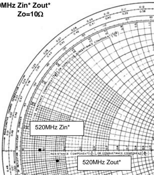
$V_{dd}=7.2V$ ,  $I_{dq}=750mA$ ( $V_{gg}$  adj.),  $P_{in}=0.7W$
