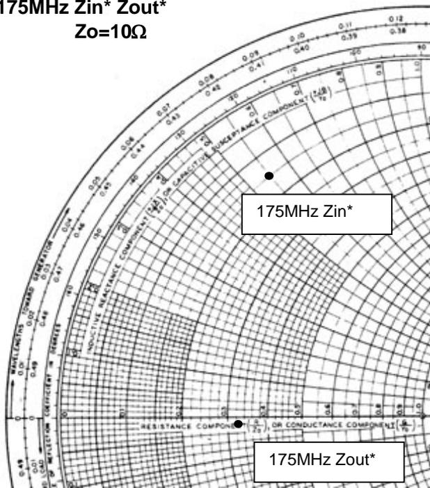
$V_{dd}=7.2V$ ,  $I_{dq}=700mA$ ( $V_{gg}$  adj.),  $P_{in}=0.28W$
