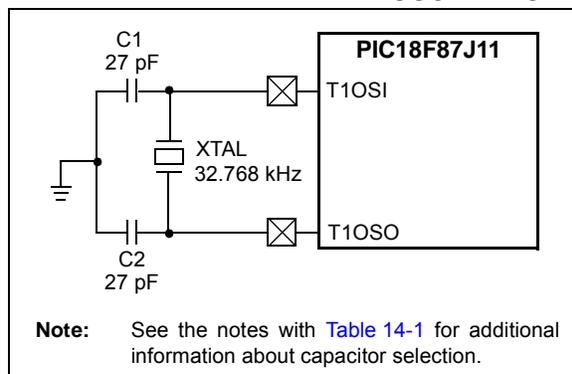
**TABLE 14-1: CAPACITOR SELECTION FOR THE TIMER OSCILLATOR<sup>(2,3,4)</sup>**
