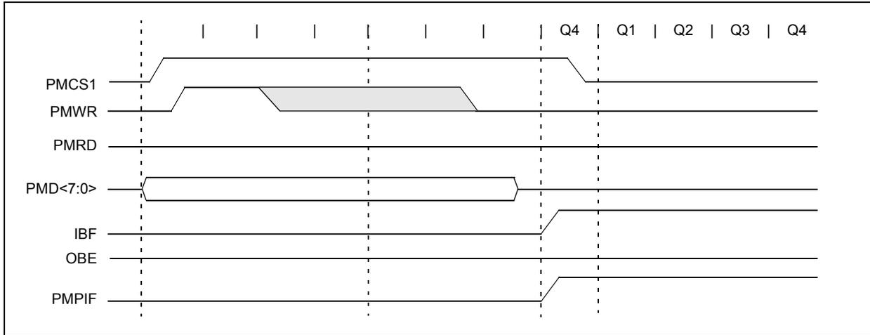
**FIGURE 12-4: PARALLEL SLAVE PORT READ WAVEFORMS**
