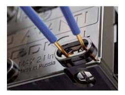
Подключение 2-х кабелей к одной контактной клемме
