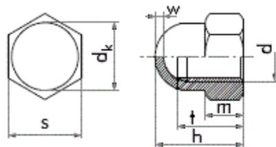
DIN 1587 Гайка колпачковая шестигранная высокая, размеры метрической резьбы от M4 до M24.
