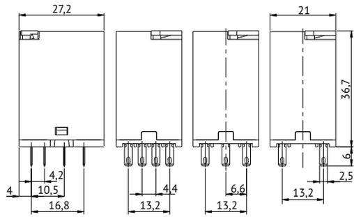
Рисунок Б.3 – Габаритные, установочные, присоединительные размеры реле OptiRel G RP55-3X с кнопкой тест
