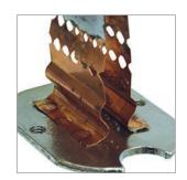
Плавкий элемент выполнен из фосфористой бронзы (сплав меди с цинком с добавлением фосфора) и надежно соединен точечной сваркой с выводами предохранителя.
