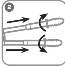
**Установите необходимую длину и зафиксируйте рукоятки, повернув их в противоположную сторону (для ТР-8Т, ТР-12Т).**
