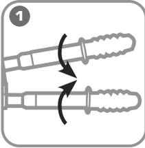
**Расфиксируйте рукоятки, повернув их вокруг оси (для ТР-8Т, ТР-12Т).**
