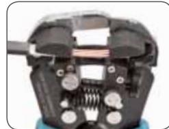
Одновременное снятие изоляции с трех проводов
