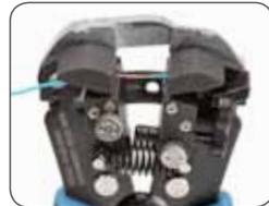
Снятие изоляции с микропровода
