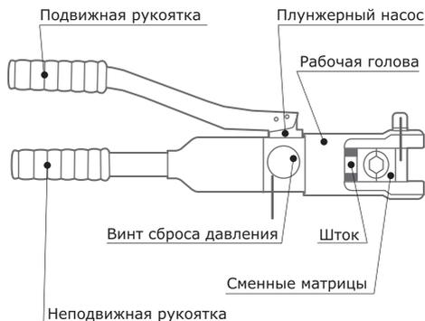
Внутри гидравлического узла с одной стороны смонтированы рабочий поршень с манжетой, пружина для возврата поршня в исходное положение, с другой – нагнетательный цилиндр и плунжер. При качании рычага пресса плунжер насоса, совершая возвратно-поступательное движение, создает избыточное давление, в результате чего масло под давлением попадает в рабочий цилиндр и перемещает рабочий поршень. Поршень, в свою очередь, воздействуя на подвижную матрицу,
