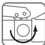
6. Отвернуть на пол-оборота запорный клапан, при этом поршень возвращается в исходное положение.
