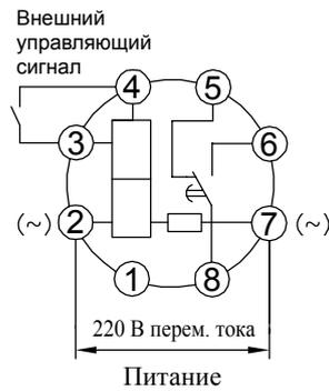
Рис. 12. Схема подключения JSZ3K (220 В)
