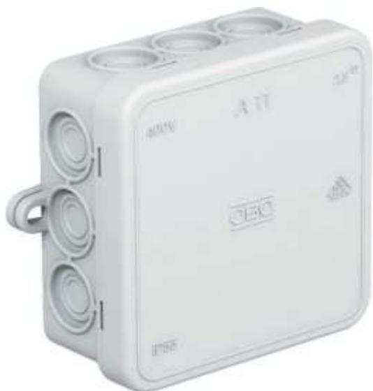
Уровень защиты IP55, номинальное сечение  $2.5 \div \text{мм}^2$ , 12 входов для кабелей диаметром 5–14 мм.
