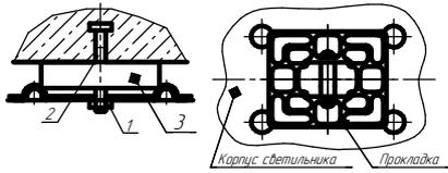
Рисунок 3.2. Вариант 2. Прокладка для установки непосредственно на поверхность из нормальнооблапленных материалов.
