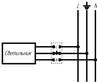
Схема подключения светильника к сети
