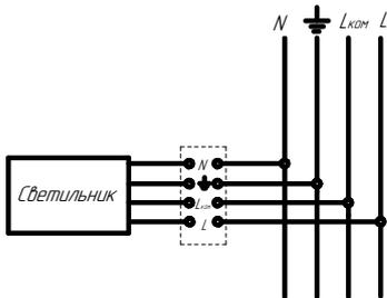
Схема подключения светильника к сети с БАП
