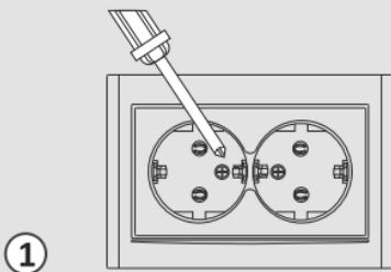
Подсоединить провода, поместив зачищенные концы в пазы контактных зажимов, затянуть винты.
