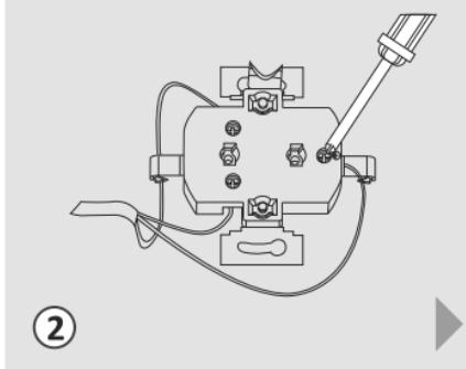
Установить механизм изделия в углубление в стене, зафиксировав его стопорными винтами с лицевой стороны механизма, затянув до упора.
