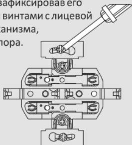
Установить крышку и закрутить винт.
