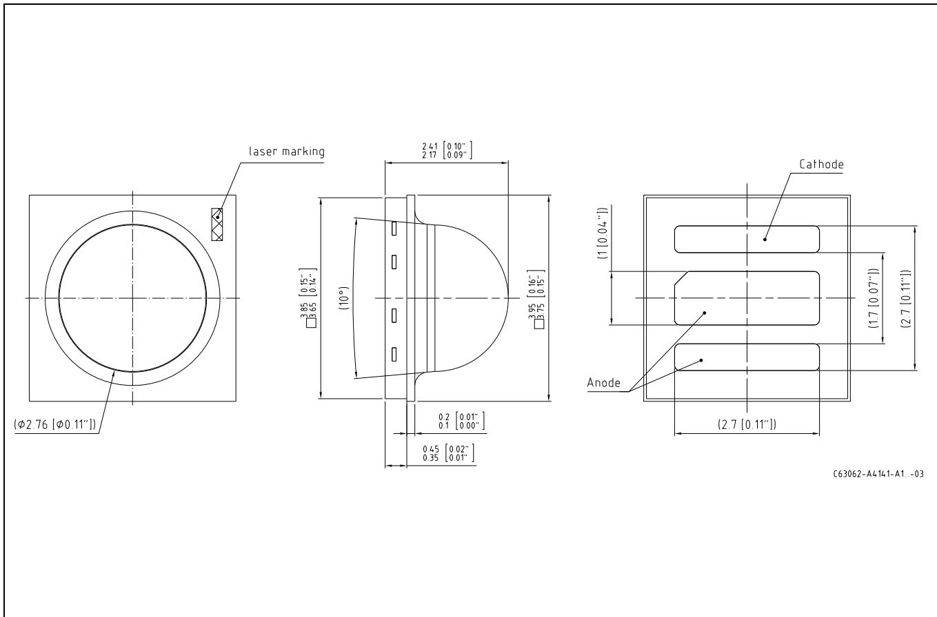
Note: Die IRED enthält ein ESD-Schutzbauteil, das parallel zum Chip geschaltet ist. / IRED is protected by ESD device which is connected in parallel to chip.
