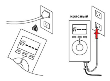
Измерительные провода мультиметров выполнены несъёмными, что исключает их утрату при эксплуатации.
