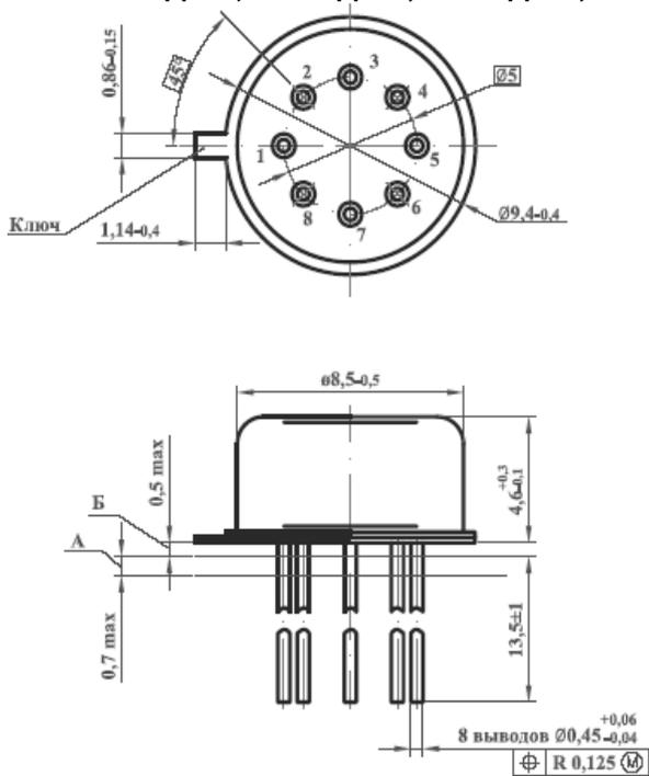
Корпус 3101.8-1, размеры в мм
