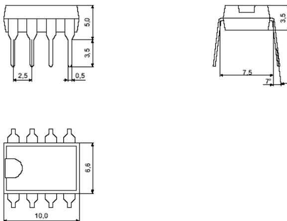
Корпус 2101.8-1, размеры в мм
