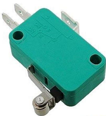
Микропереключатель RUICHI KW1-103-6, ON-(ON) SPDT, 5 А, 125 В представляет собой коммутационное устройство с механическим приводом. Он используется в качестве исполнительных устройств дистанционного управления, а также в качестве базового элемента для ряда коммутирующих изделий: кнопок, кнопочных, клавишных и других переключателей.
