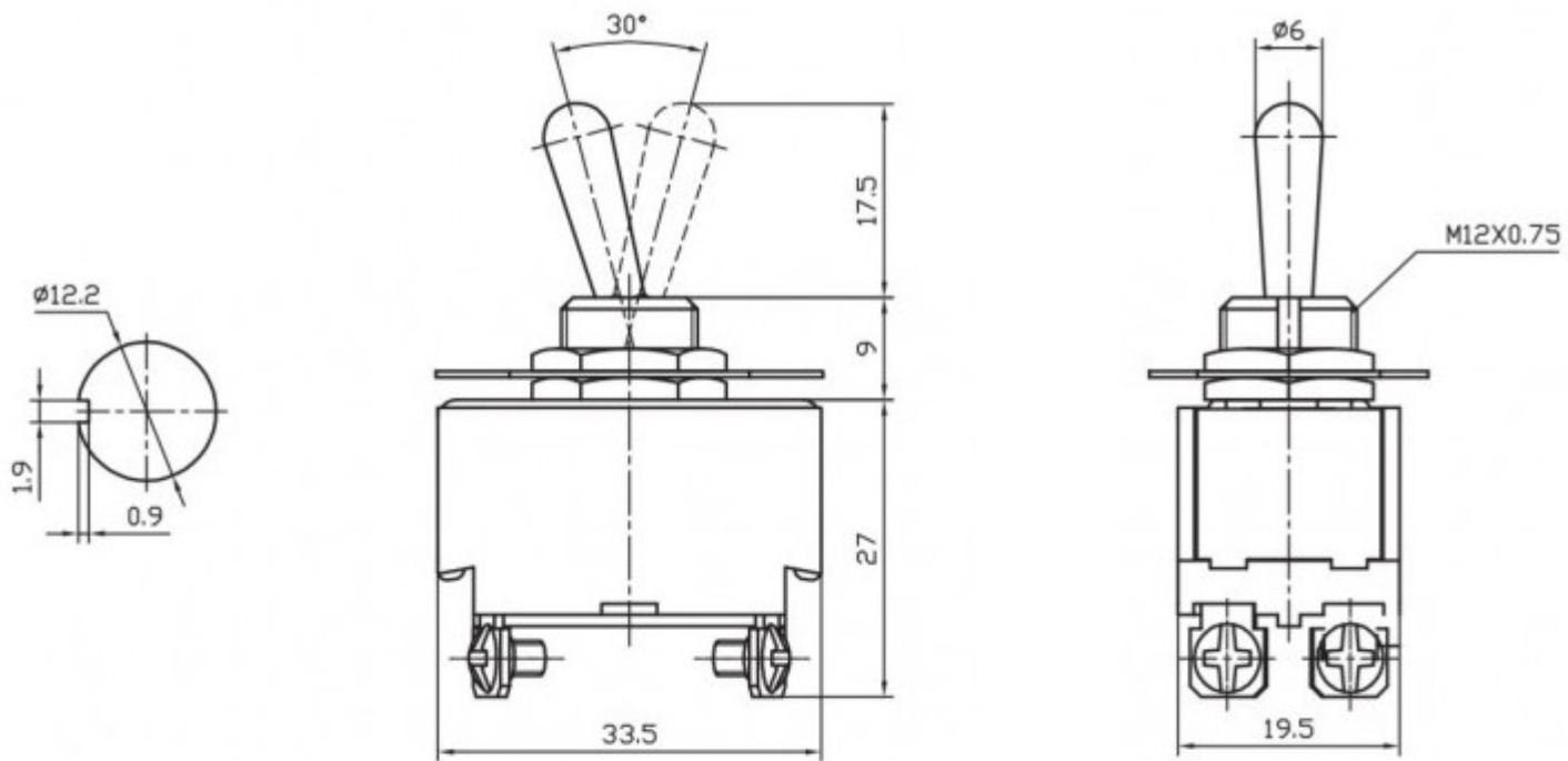
**Тумблер двухпозиционный однополюсный KN3(B)-201**
