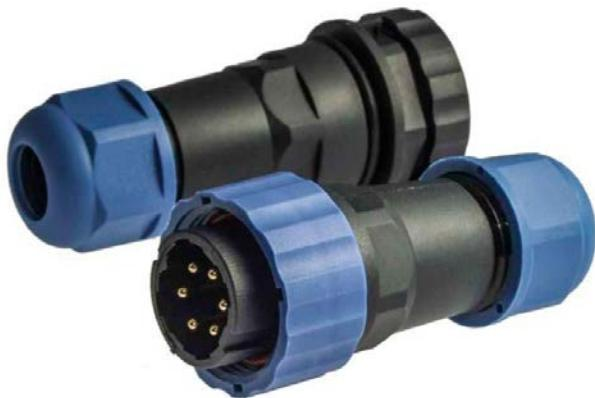
Герметичный разъем (комплект) с заглушкой SZC21 6P-F-M, вилка-розетка, 6 контактов, диаметр входящего кабеля 12 мм, IP68, 10 А, 250 В, является пылезащищенным и влагозащищенным. Герметичный разъем соответствует высокой степени защиты, что гарантирует работу разъемов при длительном погружении в воду (более 30 минут) на глубину больше 1 м.
