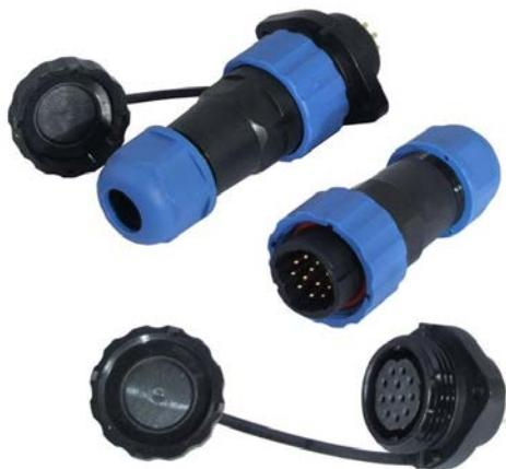
Герметичный разъем (комплект) с заглушкой SZC21 12P-M-FE, вилка-розетка, 12 контактов, диаметр входящего кабеля 12 мм, IP68, 5 А, 250 В, является пылезащищенным и влагозащищенным. Герметичный разъем соответствует высокой степени защиты, что гарантирует работу разъемов при длительном погружении в воду (более 30 минут) на глубину больше 1 м.
