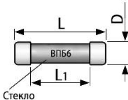
Габаритные и установочные размеры вставки плавкой ВПБ6.
