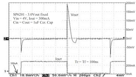
Fig. 35: Load Transient Response, 300mA step, 4V<sub>IN</sub>
