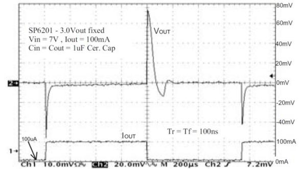
Fig. 33: Load Transient Response, 100mA step,  $7V_{IN}$
