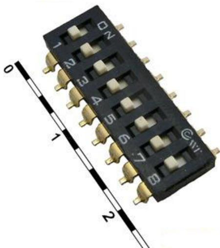
DIP-переключатель RUiCHI, серия SWD 4-8, 30 мОм, 8 (ON-OFF) с шагом 2,54 мм — это такой элемент управления, который можно встретить на многих старых платах компьютеров. Этот элемент управления представляет собой группу из нескольких переключателей, заключенную в корпус DIP (dual in-line package). Термин DIP-переключатель (DIP Switch) может относиться как ко всей группе в корпусе ДИП, так и к отдельному переключателю из этой группы.
