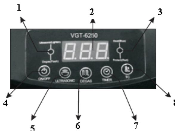
Индикатор загорается зеленым цветом - рабочее состояние. Синий индикатор подогрева - нормальное рабочее состояние. Индикатор красный - Защита от перегрева.
