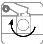
Поверните винт сброса давления в положение «Закрыто».
