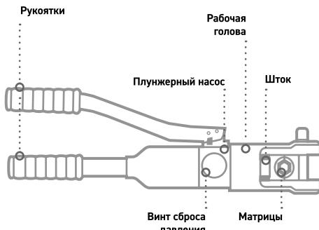
Матрицы в комплекте инструмента не относятся к какому-либо конкретному стандарту, а имеют усредненные размеры профиля обжима, с возможностью применения к арматуре распространенных стандартов: ГОСТ, DIN, КВТ. Для применения к арматуре ГОСТ ниже приведены таблицы по выбору матриц.
