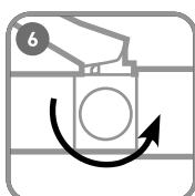
Поверните винт сброса давления в положение «Открыто»
