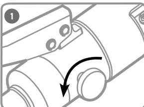
Поверните винт сброса давления в положение «Открыть»
