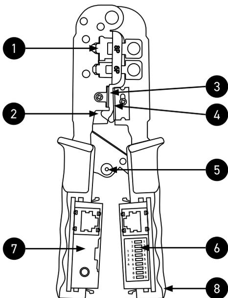
1. Зона опрессовки разъёмов
