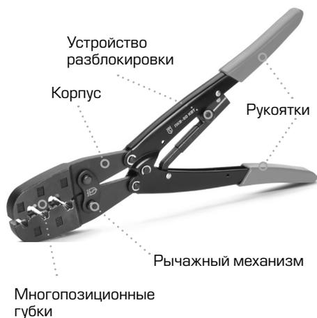
Пресс-клещи ПКВ-50, ПКВ-70 состоят из многопозиционных губок, рукояток, рычажного механизма, храпового механизма и устройства разблокировки
