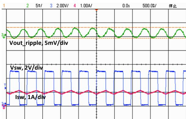
Ch2—Vout\_ripple, Ch3—Vsw, Ch4—Isw
