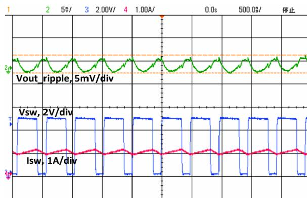
Ch2—Vout\_ripple, Ch3—Vsw, Ch4—Isw
