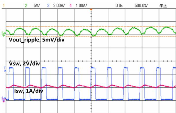
Ch2—Vout\_ripple, Ch3—Vsw, Ch4—Isw
