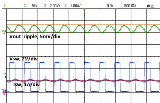
Ch2—Vout\_ripple, Ch3—Vsw, Ch4—Isw
