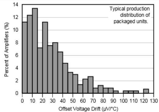
Figure 18. Offset Voltage Drift Production Distribution
