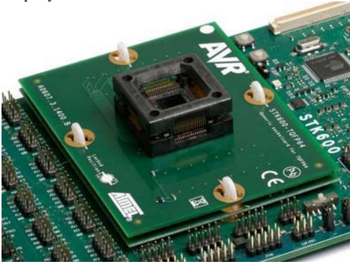
Плата-панель – карта общего назначения, которая не имеет никакого специального устройства. Например, плата-панель TQFP-64 может быть использована для всех устройств, которые идут в TQFP-64 корпусе, независимо от расположения выводов.
