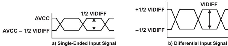
**Figure 16. TMDs Inputs**
