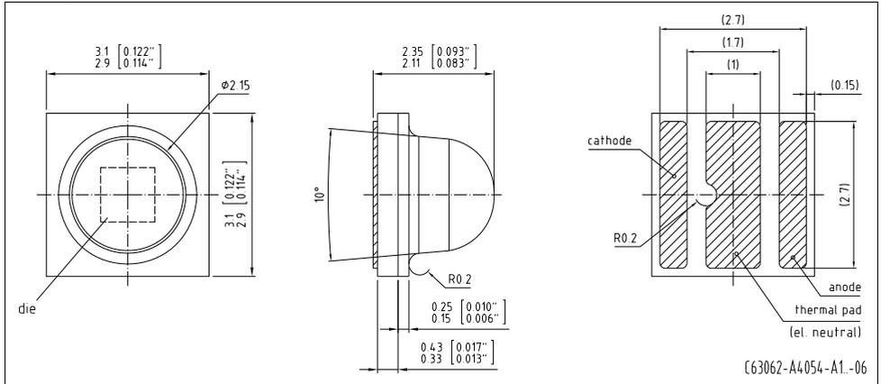
Anm.: Die LED enthält ein ESD-Bauteil, das parallel zum Chip geschaltet ist.
