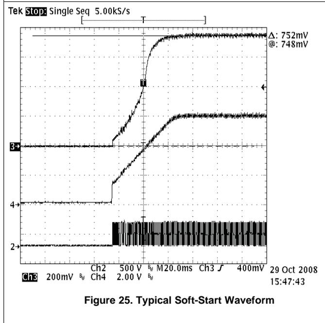
Figure 25. Typical Soft-Start Waveform
