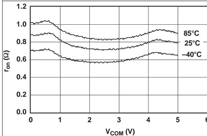
Figure 3.  $r_{on}$  vs  $V_{COM}$  ( $V_+ = 5$  V)
