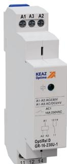
Реле промежуточное предназначено для гальванической развязки между силовыми цепями и цепями управления, дистанционного включения нагрузки путем подачи управляющего напряжения на вход реле или в качестве промежуточного реле. Применяется в следующих случаях:
