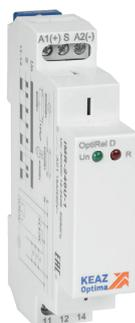
Импульсное реле — это электронное устройство, которое последовательно замыкает и размыкает встроенный контакт при подаче на вход управления короткого импульса. Для формирования управляющего импульса часто используют кнопочные выключатели, без фиксации, так называемые «выключатели звонкового типа». К контактам импульсного реле может быть подключена любая электрическая нагрузка: лампа, светильник, электродвигатель, электрический замок.
