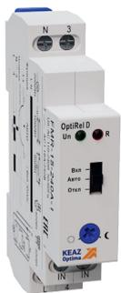
Реле сумеречное – это устройство, основная задача которого – контроль освещенности и отключения/включения нагрузки при превышении (понижении) уставки по датчику освещенности (автоматическое включение и выключение освещения с учетом времени суток). В основе работы устройства лежит фоторезистор, улавливающий изменения освещенности.
