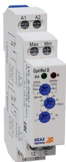
Реле контроля уровня предназначены для регулировки и поддержания заданного уровня жидкости в каком-либо резервуаре. Получая сигнал от датчиков контроля уровня, расположенных в резервуаре, устройство управляет работой исполнительных механизмов — электродвигателей насосов, электромагнитных клапанов и т.д. С помощью реле можно осуществить работу насоса в автоматическом режиме, обеспечить защиту от сухого хода, контроль протечки жидкости. Также применяются в схемах автоматики и защиты.
