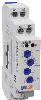
Реле предназначено для контроля уровня тока в однофазных цепях переменного тока и отключения нагрузки при превышении или снижении относительно уставки по току с регулируемой выдержкой времени. Принцип действия основан на сравнении внешних электрических сигналов и мгновенном реагировании при их несовпадении с параметрами работы прибора. Используется для работы генераторов, насосов, автомобильных двигателей, станочного оборудования, бытовых приборов и пр.
