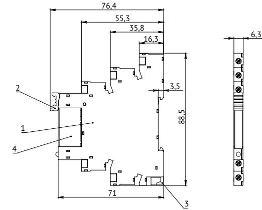
1 – корпус; 2 – фиксатор; 3 – защелка; 4 – реле
