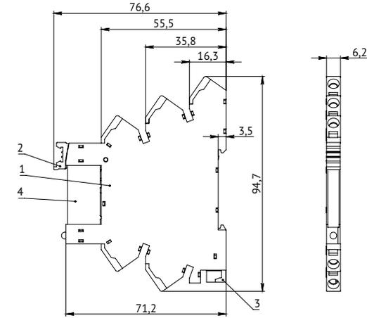
1 – корпус; 2 – фиксатор; 3 – защелка; 4 – реле
