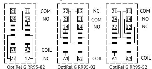
Рисунок В.1 – Принципиальная электрическая схема розеток OptiRel G RR95
