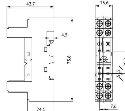
Рисунок Б.2 – Габаритные, установочные и присоединительные размеры розеток OptiRel G RR95-82
