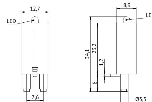
Примечание – LED установлен только в модулях OptiRel G DI, в модулях OptiRel G отсутствует
