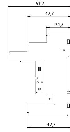
Рисунок Б.3 – Габаритные, установочные и присоединительные размеры розетки OptiRel G RR95-02
