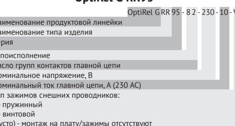
Рисунок А.1 – Структура условного обозначения розеток OptiRel G RR95
