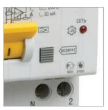
Кнопка «ВОЗВРАТ» для приведения защитного механизма в рабочее состояние и индикации срабатывания от дифференциальных токов. Светодиодная индикация наличия напряжения на клеммах «Нагрузка».
