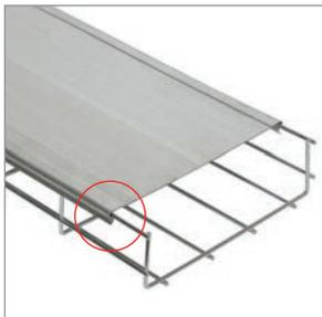
Верхняя продольная проволока лотка немного выступает за габариты лотка, что позволяет использовать совместно с лотком замковую крышку. Замок на крышке позволяет ей надежно держаться при вертикальном монтаже кабельной трассы.
