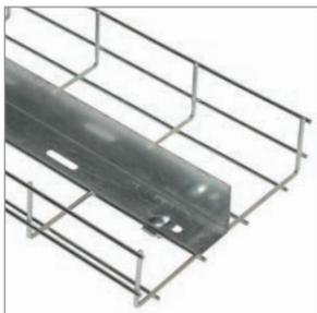
Совместно с лотком может использоваться перегородка, которая служит для разделения лотка на два и более отдела в случае монтажа в одном лотке проводки разного типа (информационной и силовой) для исключения наводок.
