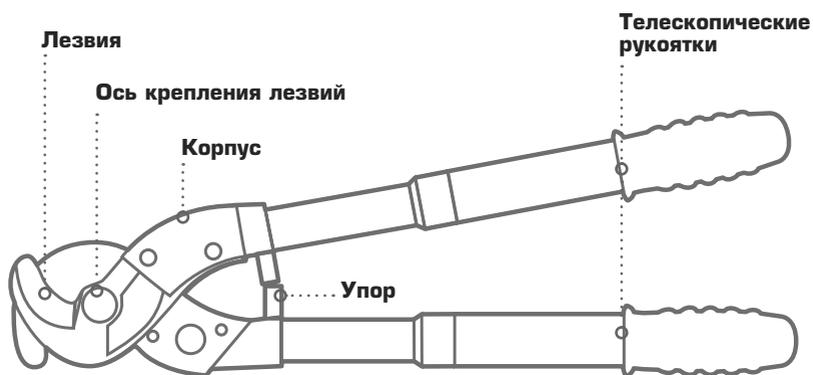
Ножницы кабельные НКТ-30 состоят из лезвий, оси крепления лезвий, телескопических рукояток.
