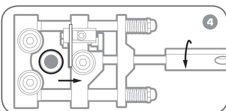
Вращая рукоятку инструмента, отведите каретку на достаточное расстояние. Аккуратно снимите инструмент с кабеля, оберегая его от случайных повреждений и задиров поверхности.
