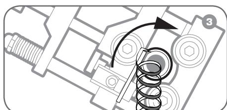
Вращая инструмент за рукоятку вокруг кабеля по спирали, снимите полупроводящий экран на необходимую длину. В конце движения сделайте оборот перпендикулярно оси кабеля для формирования равномерного среза.
