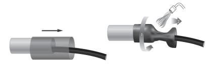
При одиночной прокладке термоусаживаемую манжету расположить симметрично относительно края трубы кабельного прохода таким образом, чтобы середина манжеты совпадала с торцом трубы. Последовательно усадить манжету, начиная с края расположенного на трубе кабельного прохода.
