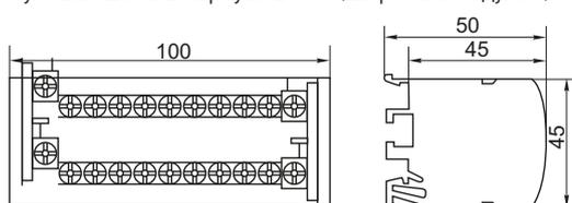
Нулевая шина в корпусе 4 x 7 (ширина 4 модуля)
