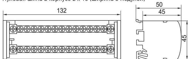
Нулевая шина в корпусе 4 x 11 (ширина 6 модулей)
