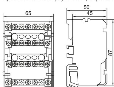
Нулевая шина в корпусе 4 x 15 (ширина 8 модулей)
