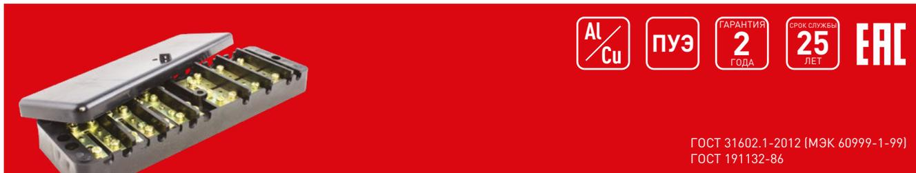
Коробка испытательная ККИ1-1 EKF PROxima обеспечивает закорачивание вторичных цепей измерительных трансформаторов тока, отключение токовых цепей и цепей напряжения в каждой фазе счетчиков при их замене. В соответствии с ПУЭ-7 (раздел I, п. 1-5-23) трансформаторные трехфазные счетчики необходимо подключать через испытательную переходную коробку.
