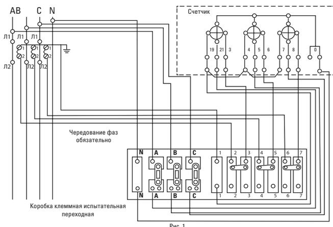
Рис. 1. Схема электрическая принципиальная «Звезда» подключения коробки испытательной переходной к трехфазной четырехпроводной сети 3 x 230/400 В (3 x 57,7/100 В) 50 Гц и трехфазным счетчиком с трансформаторным включением фазных токовых цепей с общим нулем.
