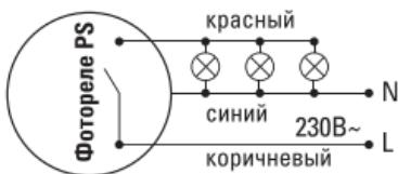
Рис. 1 - Схема подключения
