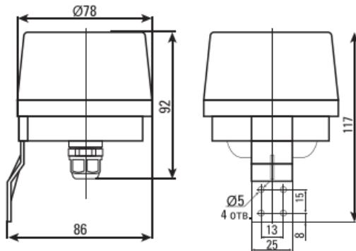
Рис. 5 - Габаритные и установочные размеры фотореле PS-4, PS-5
