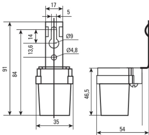
Рис. 2 - Габаритные размеры PS-1
