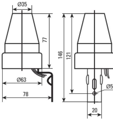
Рис. 3 - Габаритные размеры PS-2
