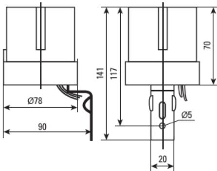
Рис. 4 - Габаритные размеры PS-3
