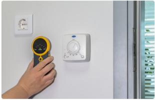
Детекторы Navigator NMT-De01/NMT-De02 используются для поиска металла и проводки внутри стен и конструкций. Приборы позволяют обнаружить находящиеся под напряжением и без напряжения электрические провода, металл, а также деревянный каркас.
