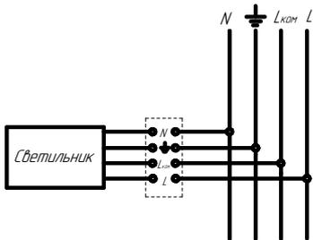
Схема подключения светильника к сети с БАУ
