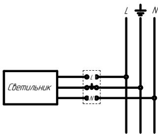
Схема подключения светильника к сети
